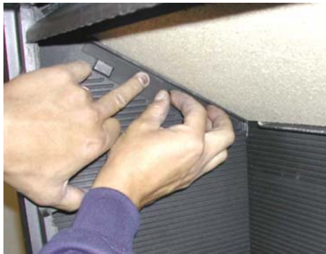
afb. 3. Plaats links in de verbrandingskamer het hoekijzer onder de keerplaat.
