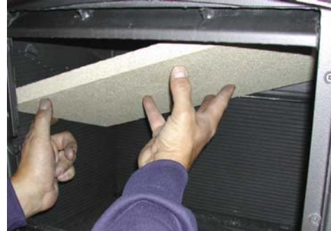
fig.2. Insérer la chicane dans la chambre de combustion. A droite de l'appareil, la poser sur la nervure en fonte prévue à cet effet.
